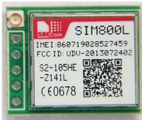
Figura 2.4. Módulo GSM/GPRS sim800L, com bluetooth e receptor de rádio FM integrados
