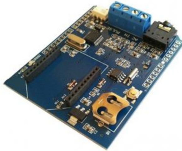
Figura 2.10. Energy shield baseado no ADE7753
